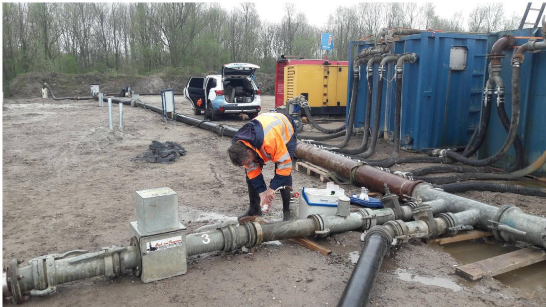
Figuur 12.16 Monstername voor analyse waterkwaliteit door KWR
