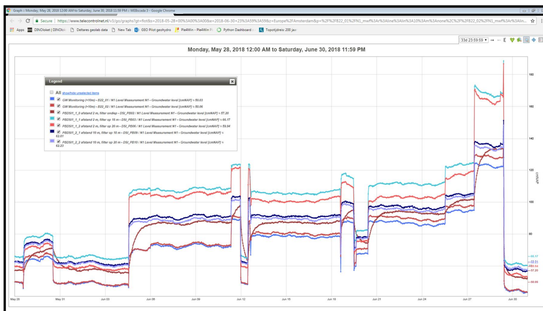
Figuur 10.6 Stijghoogteverandering bij DSI-streng 1 in het retourveld
