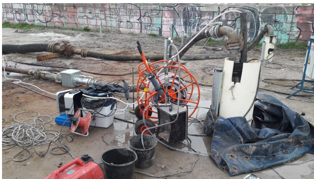
Figuur 12.14 Bemonstering PP1 voor waterkwaliteitsanalyse door KWR
