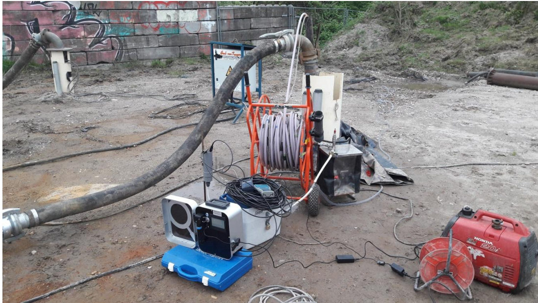
Figuur 12.15 MFI-meting PP1 door KWR. MFI = Membraan Filtratie Index
